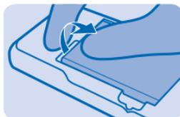
3. Levante a tampa do compartimento do SIM1 e insira o chip com a área de contato voltada para baixo.
