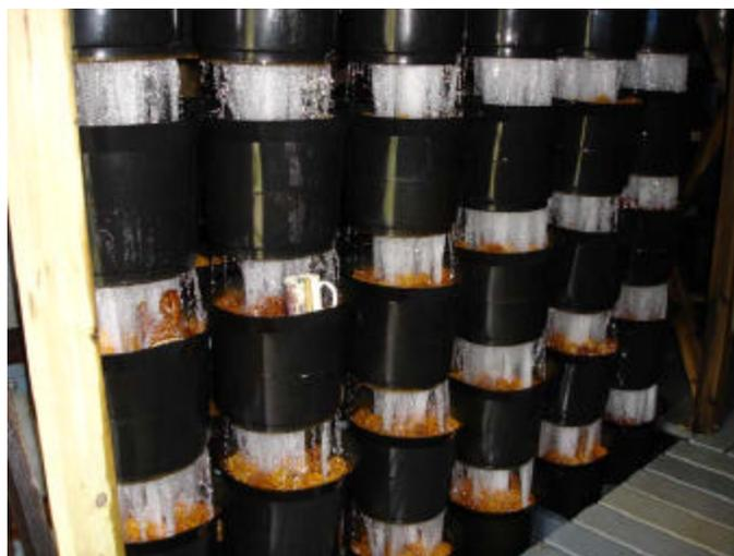
**Figura 14. Aeração da água feita por queda livre da água passando por estrutura que aumenta a superfície de contato**
