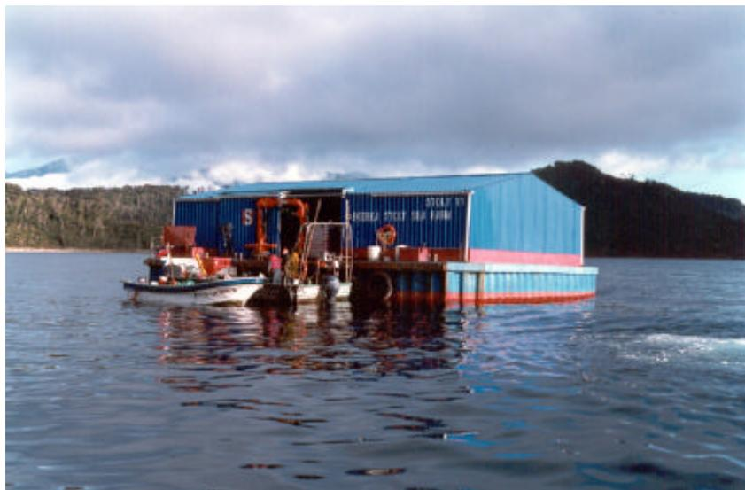
**Figura 2. Galpão flutuante para estocagem de alimento, capacidade para 120t**
