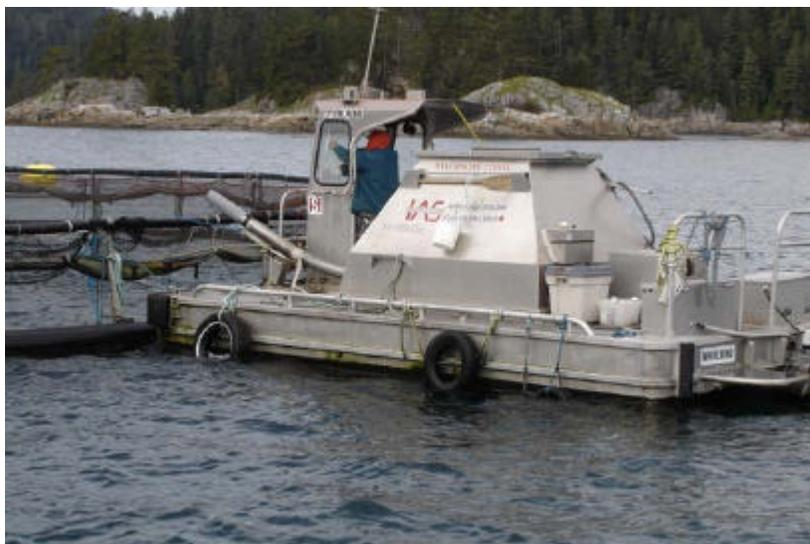
**Figura 21. Barco alimentador, possui câmeras submarinas e depósito de alimento**
