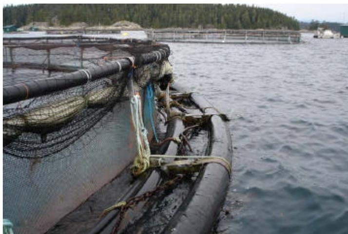
**Figura 22. Tanque rede com proteção contra algas tóxicas**
