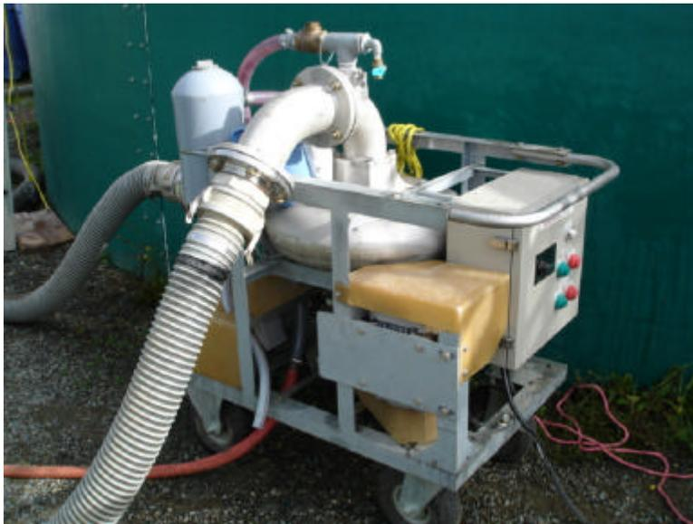
**Figura 16. Máquina usada para a transferência dos peixes**
