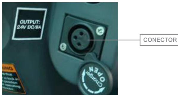
Figura 9: Conector do carregador externo no guidom.
