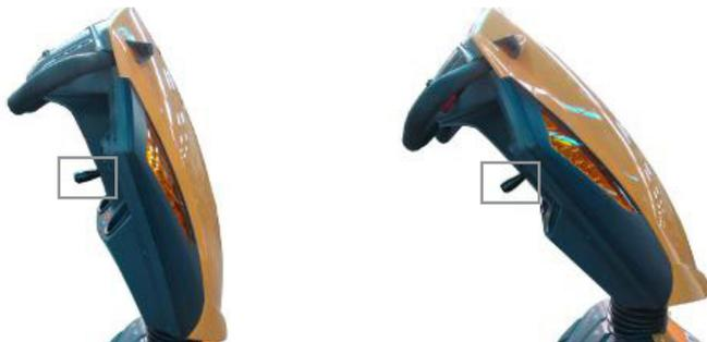
Figura 3: Ajuste da inclinação do guidom. No detalhe, alavanca de ajuste.
