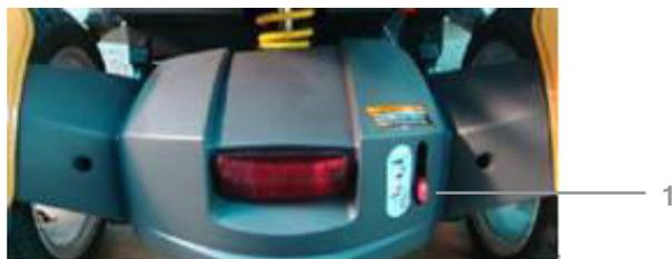
Figura 2: Alavanca de engate na parte traseira do *scooter*.
