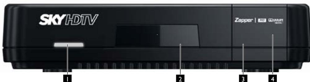
**1 LED INDICATIVO:** Led apagado indica que o aparelho está em stand by ou desligado. Led aceso indica que o aparelho está ligado. Essa luz também pisca quando o receptor recebe um sinal do controle remoto.
