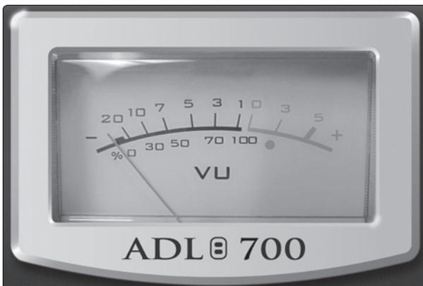
**Medidor VU:** O medidor VU analógico mostra o nível de saída do ADL 700. Quando a chave de medidor GR é ativada, o VU passa a exibir a quantidade de redução de ganho aplicada pelo compressor.
