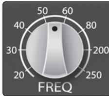
**Frequência da Banda Grave:** Ajusta a frequência central da banda grave do EQ. Você pode ajustar a frequência central de 20 a 250 Hz.
