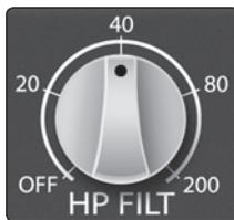
**Filtro Passa Altas:** O threshold da frequência do filtro passa altas pode ser ajustado em 20 Hz, 40 Hz, 80 Hz ou 200 Hz, ou pode ser desligado completamente. A curva do filtro é de -12 dB/oitava.
