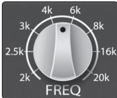
**Freqüência da Banda Aguda:** Ajusta a freqüência central da banda aguda do EQ. Você pode ajustar a freqüência central de 2 kHz a 20 kHz.
