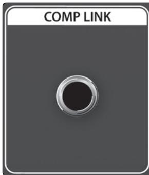
**Comp Link:** Utilize essa conexão P10 estéreo para vincular o estágio de compressor de dois ADL 700.
