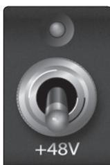
**+48V.** A alimentação fantasma 48 volts, fornecida através da entrada XLR, fornece energia em um nível constante para microfones condensadores e outros dispositivos.
