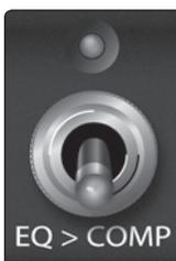
**EQ>Compressor:** Quando a chave EQ>Compressor é ativada, ela põe o EQ antes do compressor no caminho do sinal. Quando desativada, o sinal passa através do compressor antes de passar através do EQ.
