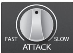
**Attack (Ataque):** O ataque ajusta a velocidade na qual o compressor age no sinal de entrada. Um tempo lento de ataque (totalmente no sentido horário) faz com que o componente inicial do sinal (chamado de transiente inicial) passe livre, sem compressão, enquanto que um tempo rápido de ataque (totalmente no sentido anti-horário) aciona a compressão imediatamente assim que o sinal excede o threshold. O tempo de ataque do compressor vai de 0.5 ms (Rápido) até 10 ms (Lento).
