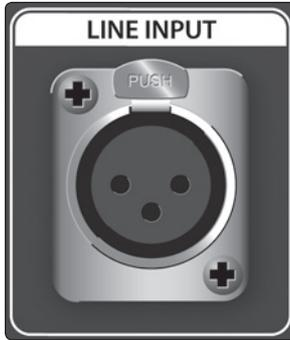
**Entrada de Linha (Line):** Essa conexão XLR balanceada pode ser utilizada para dispositivos em nível de linha, como teclados, baterias eletrônicas, etc. Você também pode utilizar as entradas de linha em dois ADL 700 vinculados (Link), para obter uma mixagem estéreo mais rica. Para utilizar esta entrada, gire a seleção de fonte para a posição "Line".
