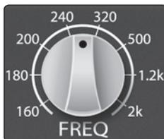
**Frequência da Banda Médio-Grave:** Ajusta a frequência central da banda médio-grave do EQ. Você pode ajustar a frequência central de 160 Hz a 2 kHz. A banda médio-grave tem um Q fixo de 0.6.
