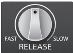
**Release (Liberação):** Ajusta o release do compressor, que é o tempo que o compressor leva para que a redução de ganho retorne a zero (sem redução de ganho) após o nível do sinal estar abaixo do threshold da compressão. O tempo de release do compressor vai de 40 ms (Rápido) até 500 ms (Lento).
