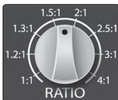
**Ratio (Razão):** O controle Ratio ajusta a curva da compressão, que é a relação entre o nível de saída e o nível de entrada. Por exemplo: se você tem o ratio ajustado em 2:1, para cada 2 dB de aumento no nível acima do threshold, a saída do compressor aumentará em apenas 1 dB. O ratio pode ser ajustado de 1:1 a 4:1.
