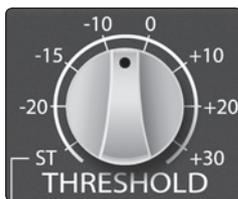
**Threshold:** Ajusta o threshold do compressor. Quando o nível de amplitude do sinal excede o threshold configurado, o compressor é ativado. Girar o controle no sentido anti-horário diminui o threshold de maneira que a compressão se inicia em uma amplitude menor, e mais do sinal de entrada é comprimido (estando o ratio superior a 1:1). O threshold pode ser ajustado de -20 a +30 dBu.
