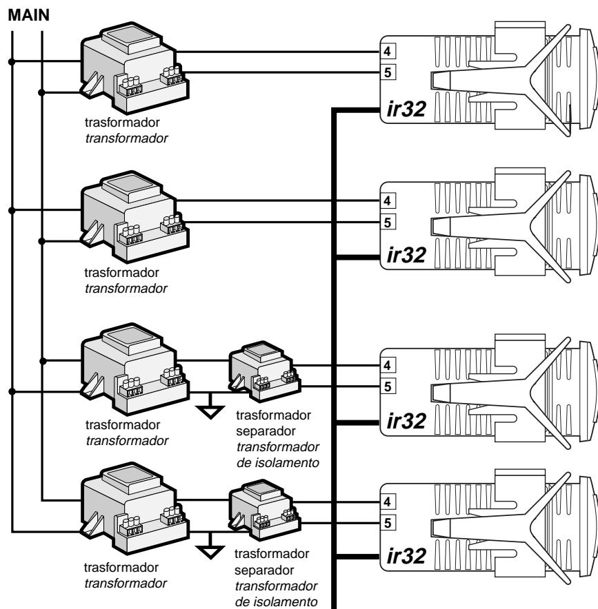
Ejemplo de cableado para una conexión serial de los instrumentos:
