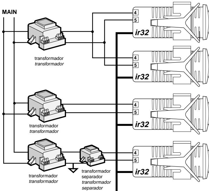
Ejemplo de cableado para una conexión serial de los instrumentos:
