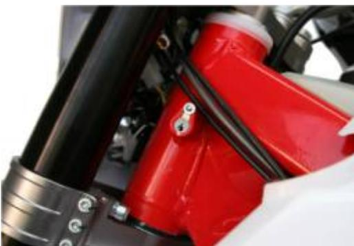
Sua GAS GAS tem um sistema para bloqueio de direção. Ele está localizado no lado esquerdo da cabeça da direção.
