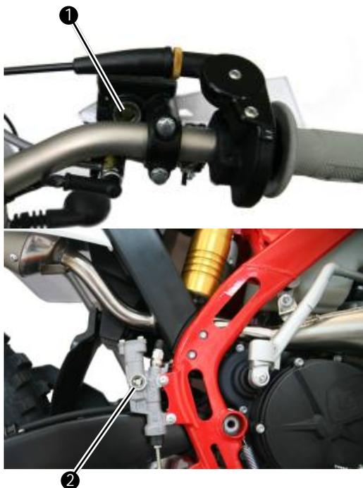
**Verificou o reservatório do fluido de freio?** Os reservatórios de fluido freios, um para cada travão, com uma viseira (1 e 2) a fim de verificar o seu nível.
