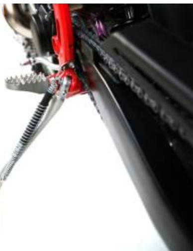
**O pedal de descanso está em bom estado?** O pedal de descanso suporte é uma parte da moto que costuma causar problemas, incluindo a segurança, porque é uma parte que recebe um tratamento severo. Se você notar um toque incomum ou dificuldade em sua retirada deve primeiro realizar uma limpeza completa de todo o conjunto e verifique o aperto da fixação e do estado das docas. Se a avaria continuar, você deve leva-la imediatamente para a sua manutenção em uma revenda GasGas para sua segurança.
