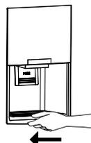
Coloque a bandeja: Simplesmente deslize-a para dentro.
