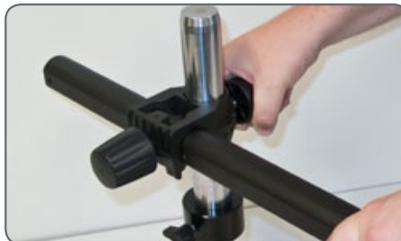
4. Oriente o anel de segurança na barra transversal e aperte o parafuso de fixação.
