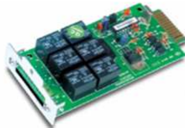
Figura 16: vista geral da placa de relés
