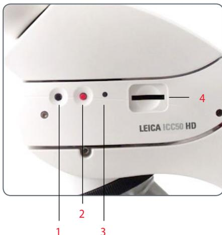
1. Botão multiuso preto: Pressione por 1 segundo – exibe as configurações de iluminação. Pressione por 5 segundos – alterna entre o modo HD e modo PC
