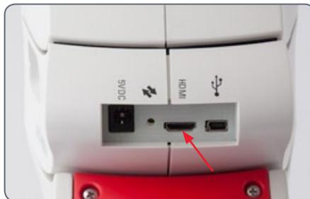
2. Conecte o cabo HDMI à televisão ou monitor HDMI.
