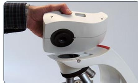
4. Aperte o conjunto de parafusos firmemente, mas sem forçá-lo.
