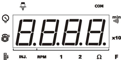
O visor dispõe de quatro dígitos que fornecem informações necessárias a todo procedimento de teste e limpeza dos bicos injetores.
