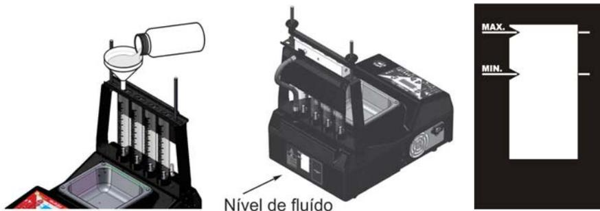
APÓS ABASTECIDO, NÃO INCLINE OU MOVIMENTE O "MULTIJET PRO" BRUSCAMENTE. DESLOQUE-O NA POSIÇÃO HORIZONTAL. PARA TRANSPORTE, RETIRE O LÍQUIDO DO RESERVATÓRIO INTERNO.
