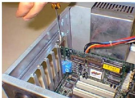
Figura 2.20 Aparafusando uma placa de expansão no gabinete.
