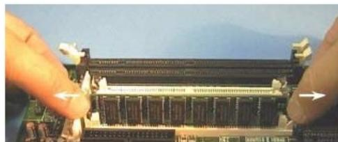
**Figura 2.7** Retirando um módulo de memória SIMM
