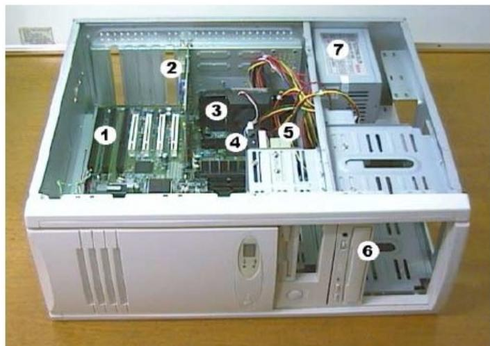
Figura 4.1 - Disposição dos componentes no gabinete ATX
