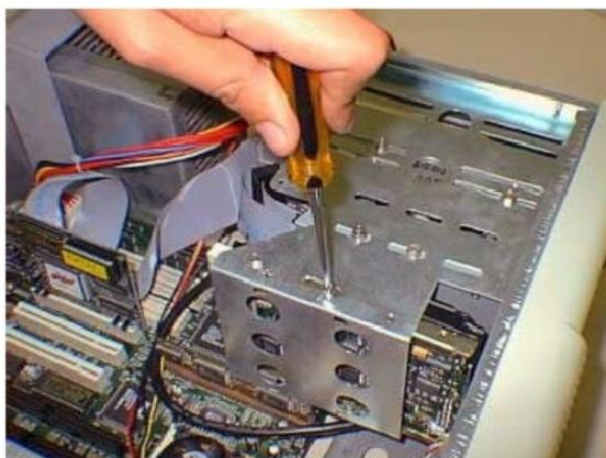
Figura 2.22 Aparafusando o disco rígido no gabinete
