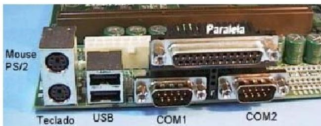
**Figura 1.22** Conectores existentes na parte traseira de uma placa de CPU ATX.
