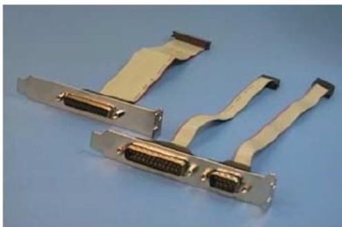
**Figura 1.21** Conectores auxiliares para as interface seriais.
