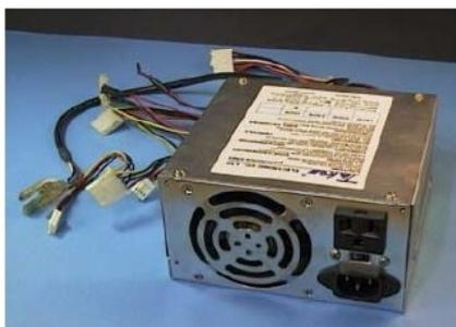
Figura 1.24 Exemplo de fonte de alimentação de um PC.
