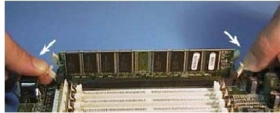
**Figura 2.9** Removendo um módulo DIMM/168.
