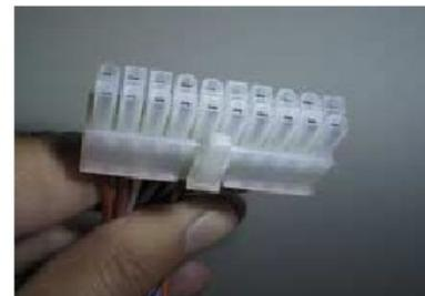
Figura 1.27 Conector de uma fonte de alimentação ATX.
