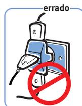
O cabo elétrico do aparelho não pode ser alterado. Não desligue o Forno da tomada puxando pelo cabo elétrico. Desligue puxando pelo plugue.
