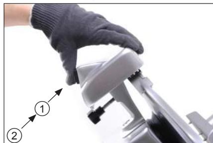
Após completar a afiação, aconselhamos a limpeza da lâmina usando uma escova pequena com sabão neutro. Em seguida retorne o afiador para a posição original.
