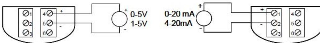
**Figura 2 Fiação de Calibração: voltagem (esquerda), corrente (direita)**
