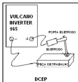
Figura 2- Conexão positiva para soldagem com eletrodo revestido
