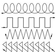
3. Deslocamento lateral do eletrodo em relação ao eixo do cordão (tecimento). Este movimento é utilizado para se depositar um cordão mais largo, fazer flutuar a escória, garantir a fusão das paredes laterais da junta e para tornar mais suave a variação de temperatura durante a soldagem. O tecimento deve ser, em geral, restrito a uma amplitude inferior a cerca de 3 vezes o diâmetro do eletrodo. O número de padrões de tecimento é muito grande. Veja ao lado.
