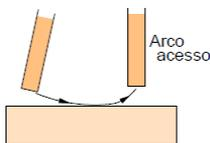
1. Movimento de mergulho do eletrodo em direção à poça de fusão de modo a manter o comprimento de arco constante. Para isto, a velocidade de mergulho deve ser igualada à velocidade de fusão do eletrodo, a qual depende da corrente de soldagem.
