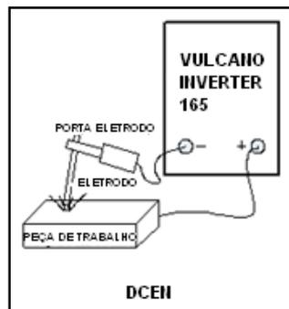
Figura 1- Conexão negativa para soldagem com eletrodo revestido
