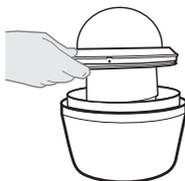
4. Coloque o anel de vedação que acompanha o produto no vinco da tampa retirada, isso evitará a entrada de água no interior da câmara;
