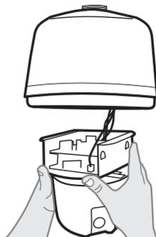
15. Acople a tampa da speed dome e aperte os dois parafusos para a perfeita fixação;
