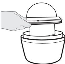
5. Coloque o anel de vedação que acompanha o produto no vinco da tampa retirada, isso evitará a entrada de água no interior da câmara;
