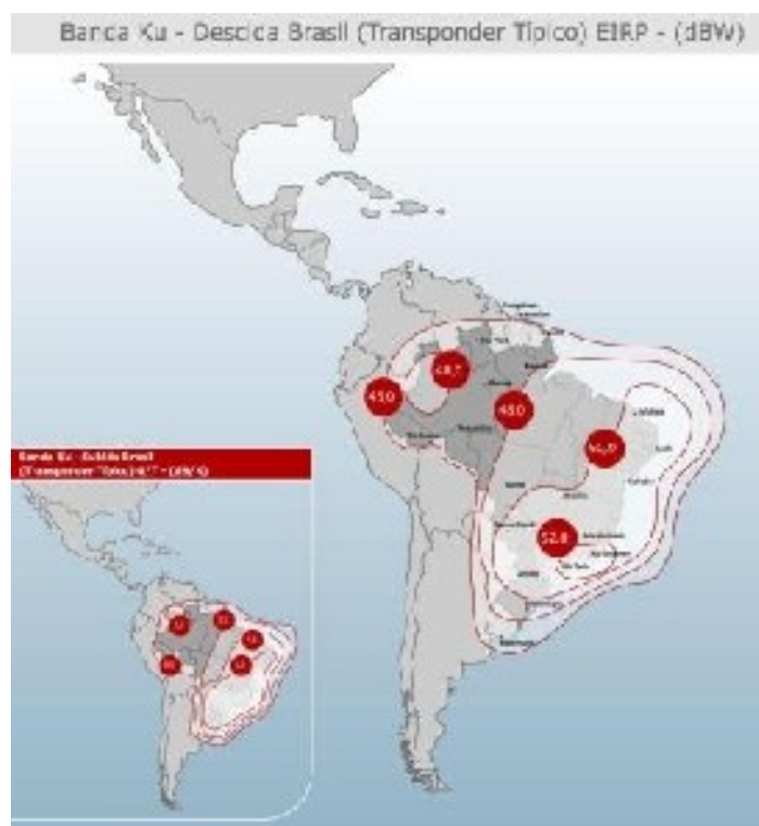
Footprint do satélite Star One C1, para Banda Ku, operado pela Star One.
