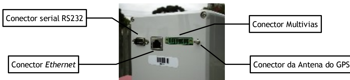
Painel traseiro do Sistema Eletrônico SAG.
