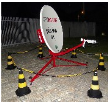
Exemplo de utilização dos cones e corrente. Disposição hexagonal.
