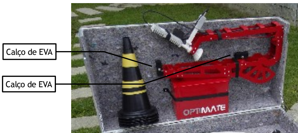
Acondicionamento da estrutura central na caixa
