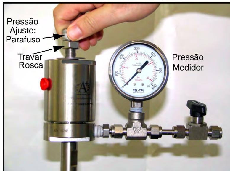
Figura 22: Rotacionando o Parafuso de Ajuste de Pressão
