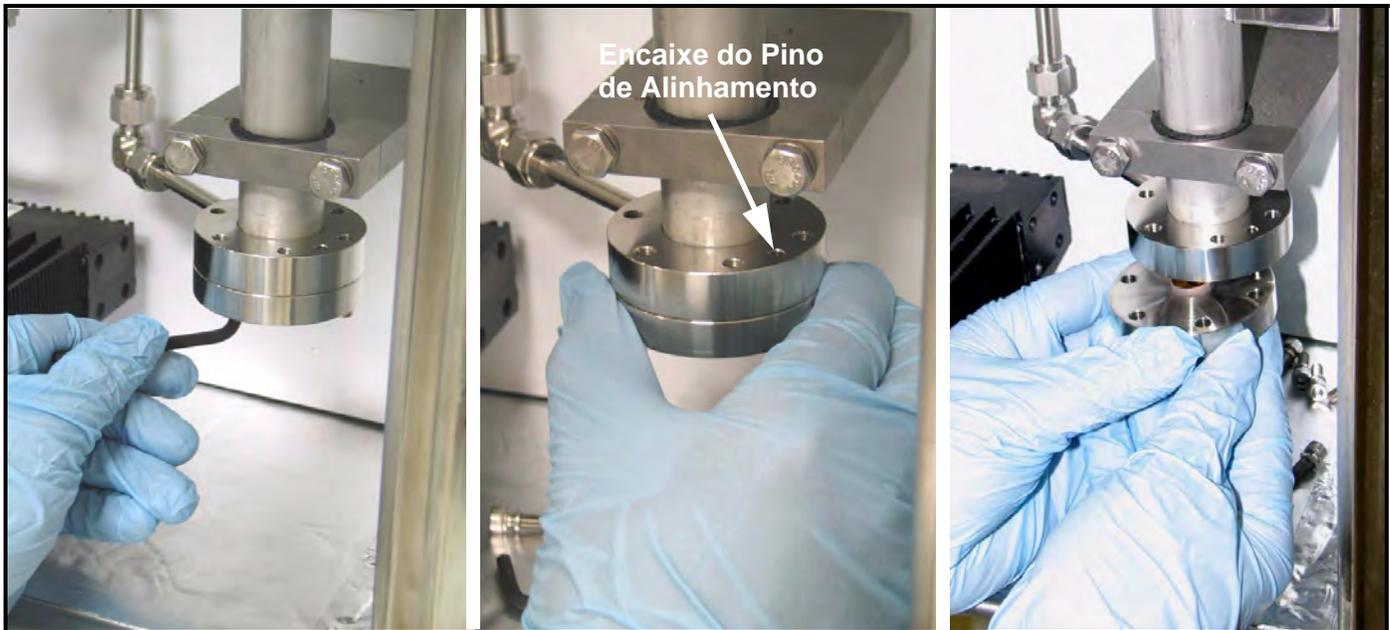
Figura 73: Removendo o Espelho do Aurora H<sub>2</sub>O
