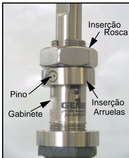
Figura 18: Encaixando a Rosca de Inserção
