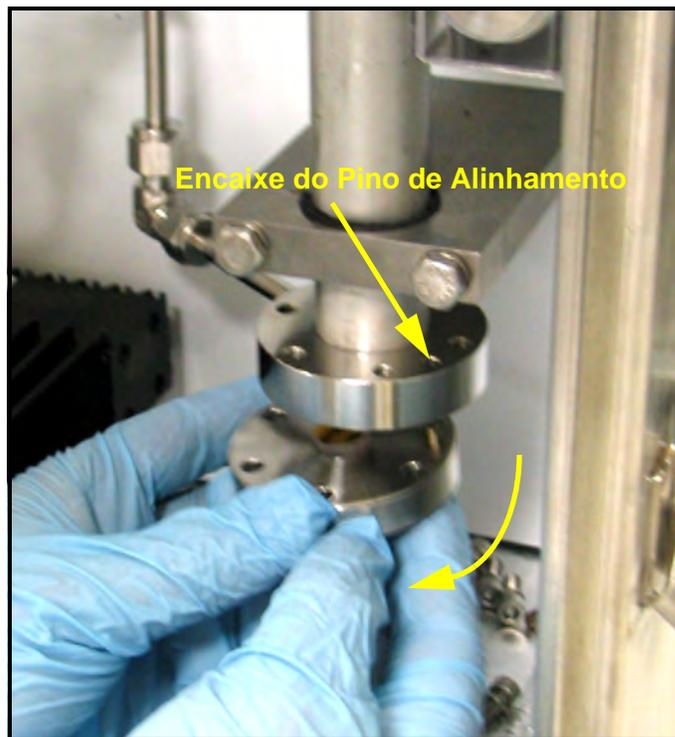
Figura 80: Reinstalando a Montagem do Espelho
