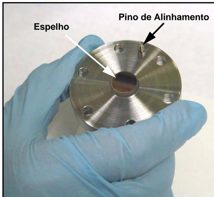
Figura 74: Manuseando a Montagem do Espelho
