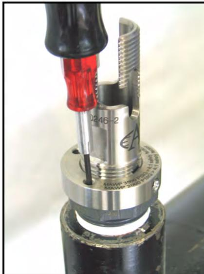
Figura 14: Apertando o Parafuso Allen
