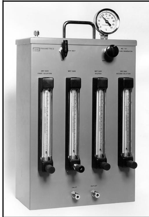
**Figura 85: Gerador de Umidade MG101**
