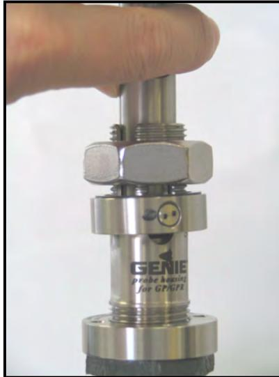
Figura 19: Rotacionando a Sonda
