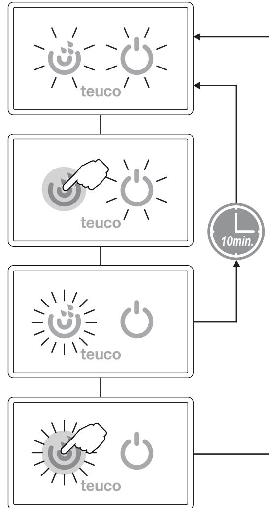
**⚠** Als het zuiveringsniveau laag is gaat de toets ZUIVEREN knipperen op hoge intensiteit en lage frequentie voor de duur van 30 secondes rijdens de startfase van de hydromassage. Vul de ontsmettingsvloeistof bij. Als de ontsmettingsvloeistof op is knippert de toets ONTSMETTEN en het ontsmetten wordt niet gestart. Druk op een toets om in stand-by terug te keren en vul de ontsmettingsvloeistof bij (zie DIAGNOSEBERICHTEN).
