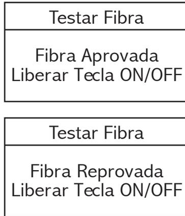
Caso o resultado seja "Fibra Reprovada" será necessário fazer a limpeza e a clivagem da fibra - veja item "FIBRA ÓPTICA". A tela de teste será exibida até que um novo teste seja realizado após a limpeza e/ou clivagem.
