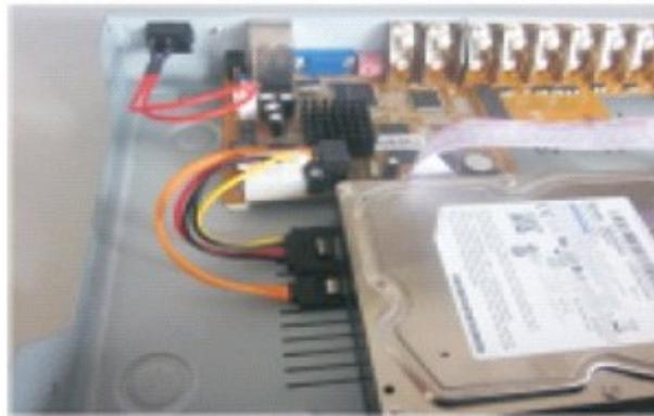
Figura 5.5 – Cabos de alimentação e dados conectados.
