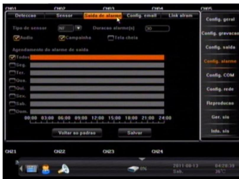
**7.4.3.1- Tipo de Sensor:** Configure o tipo do sensor NA (Normalmente Aberto) ou NF (Normalmente Fechado). Selecionado o tipo de sensor NA, significará que o Stand Alone realizará gravação (será acionado) quando a tensão de entrada do sensor estiver entre 0.7v e 12v. Já se o tipo de sensor selecionado for o NF, significará que o Stand Alone realizará gravação (será acionado) quando a tensão de entrada do sensor estiver entre 0v e 0.7v.
