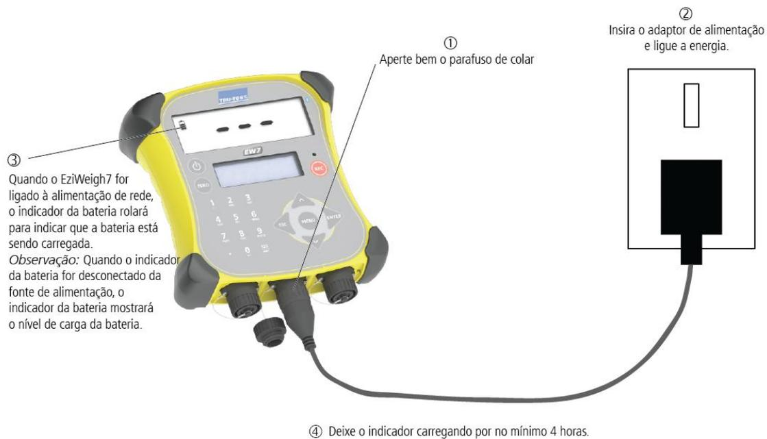
*Nota:* É possível que o indicador da bateria não seja completamente exato, se o indicador estiver sendo usado em condições de temperaturas muito frias (abaixo de 5° C).
