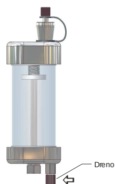
Figura 21 - Drenagem da câmara de borbulhamento
