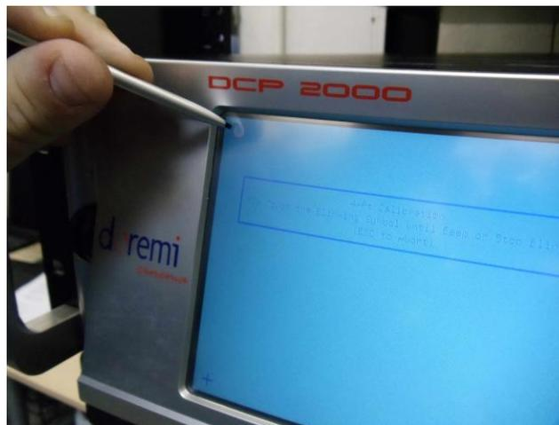
**Figura 144: Calibração da tela LCD do servidor**
