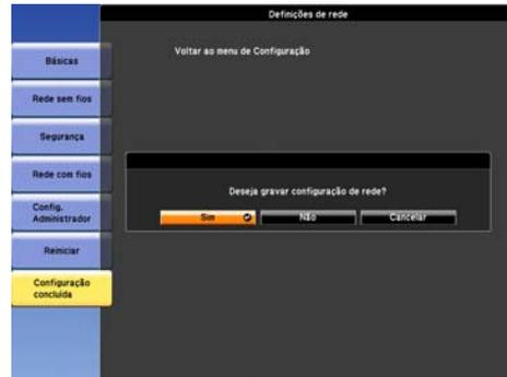
Isto completa a configuração da ligação entre o projetor e o ponto de acesso. Aperte o botão [Menu] para fechar o menu de configuração.
