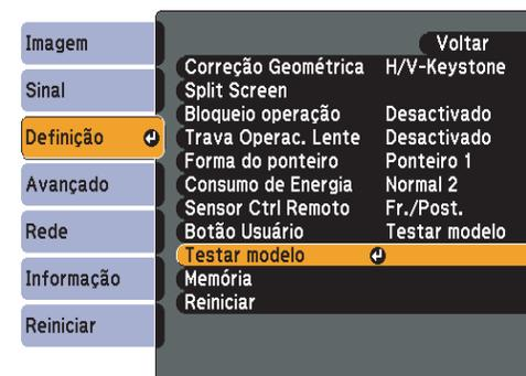
**2** Aperte o botão [⊙] no controle remoto na direção [▶] ou aperte o botão [Enter] no painel de controle para mudar o padrão de teste.
