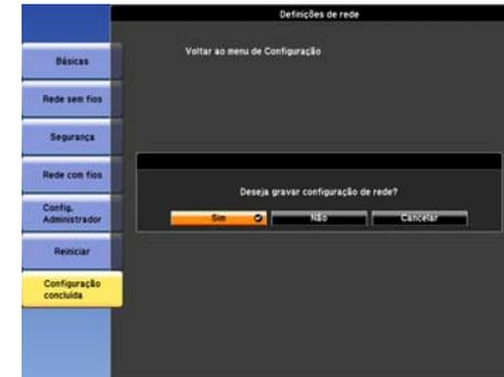
Isto completa a configuração da ligação entre o projetor e o ponto de acesso. Pressione o botão Menu para fechar o menu de configuração.
