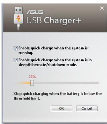
3. Mova o indicador para definir o limite de carga da bateria para a função Carregamento USB+.
