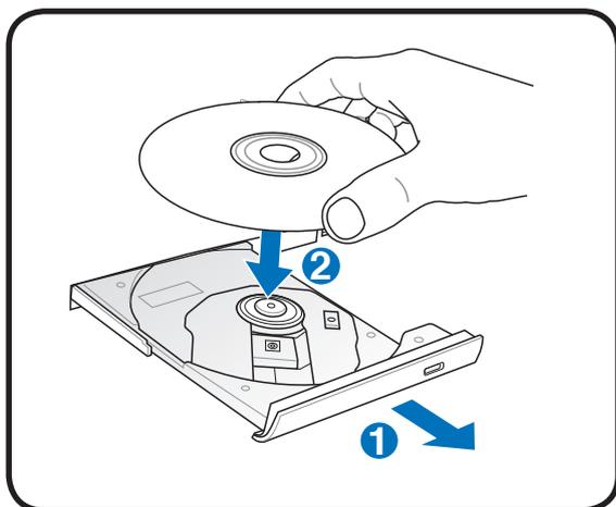
3. Segure o disco pelas pontas e coloque a parte impressa do disco para cima. Empurre em ambos os lados do centro do disco até que o disco se encaixe no núcleo. **O núcleo deve estar maior que o disco, quando corretamente montado.**
