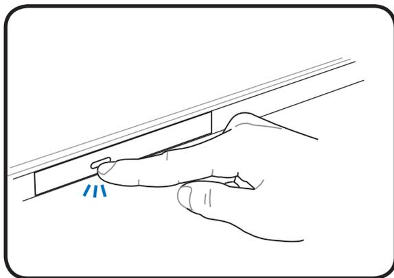
2. Suavemente, puxe o painel frontal do drive e deslize a bandeja completamente para fora. Cuidado para não tocar as lentes do drive de CD e outros mecanismos. Certifique-se que não há obstruções que possam prender-se sob a bandeja do drive.
