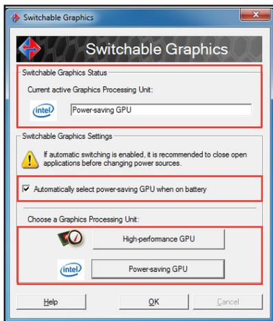
Por padrão, seu notebook é configurado para selecionar automaticamente o modo GPU ótimo dependendo da fonte de energia. Para ligar/desligar esta configuração, marque ou desmarque a caixa em frente a **Selecione automaticamente GPU de economia de energia ao usar a bateria** e então clique em OK.
