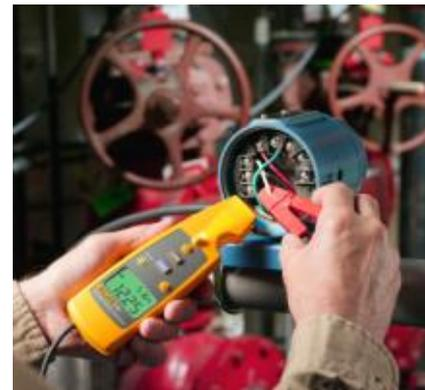
Alicate pode ser usado separadamente para medir sinais de 4 mA a 20 mA nos transmissores sem quebrar o circuito.
