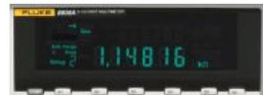
Utilize as teclas de configuração (S1-S6) para acesso rápido a medições repetitivas. As configurações podem incluir modo Limite de Comparação com indicadores passa/falha.
