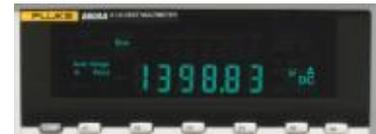
O Fluke 8808A inclui duas faixas de alta impedância e baixa corrente para medições de corrente de fuga sensíveis.
