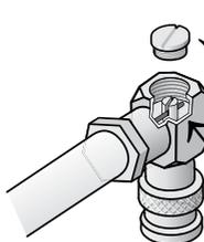
Inserir o parafuso no lugar (fazer teste de continuidade e verificar se não ocorreu curto-circuito entre a malha e o conduto interno)
