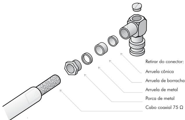
3. Retire aproximadamente 1,5 cm da capa que envolve a malha do cabo coaxial, e em seguida retire 1 cm da capa que envolve o condutor interno;
