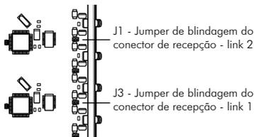
**Obs.:** estes jumpers aterram a blindagem dos conectores de recepção. Portanto, se foi constatado que existe aterramento no conector de recepção do modem, deve-se manter o jumper aberto. Se foi constatado que não existe aterramento no conector de recepção do modem, deve-se manter o jumper fechado.
