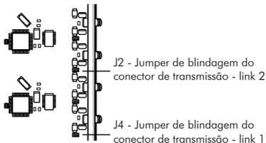
**Obs.:** estes jumpers aterram a blindagem dos conectores de transmissão. Portanto, se foi constatado que existe aterramento no conector de transmissão do modem, deve-se manter o jumper aberto. Se foi constatado que não existe aterramento no conector de transmissão do modem, deve-se manter o jumper fechado.
