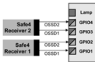
Figura 10: Conexão de até dois componentes de segurança OSSD (por exemplo, sistemas de cortinas de luz GuardShield Safe4)
