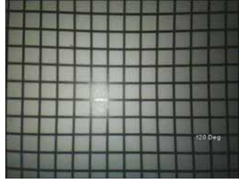
ponteira ótica de 120°, correção de distorção ativada
