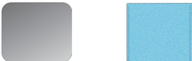
**Figura 25.** Eletrodo placa de alumínio com pano vegetal.
