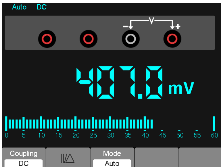
Figura 7-6 Medição de Tensão DC
