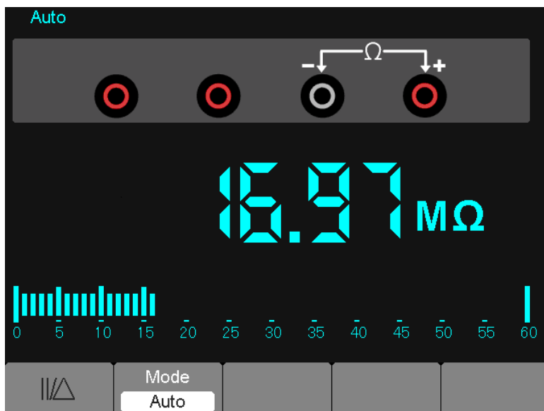
Figura 7-2 Medição de Resistência
