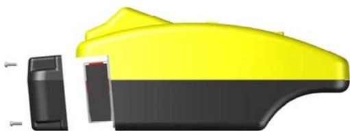
**Figura 11: Colocação da bateria
