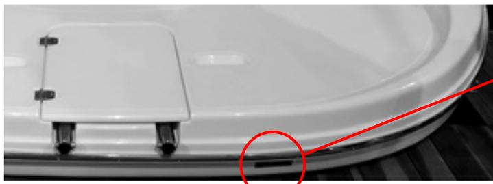
A plaqueta de identificação do casco fica localizada na popa (boreste), próximo da escada de acesso. Esta identificação segue a Norma ABNT NBR 14574-2012
