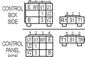
CONNECTOR (VIEW FROM INSERTING WIRE SIDE)
