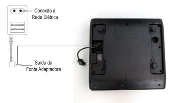
Após verificar a tensão desejada, conecte a fonte adaptadora no conector de entrada da sua Prix 3 Plus, localizado na parte inferior da base da balança, conforme exibido na figura acima.
