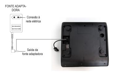
A recarga da bateria está iniciada. No início da recarga o display ficará apagado, ou seja, a balança só terá condições de funcionamento após a bateria atingir o nível mínimo de carga. Após a bateria atingir sua carga, o indicador de **Bateria Carregada** se acenderá para indicar que a carga da bateria está completa, permanecendo aceso enquanto a balança estiver conectada à rede elétrica.
