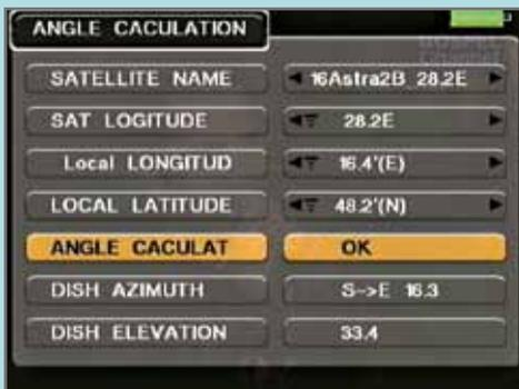
O cálculo do Ângulo simplifica a instalação de uma antena
