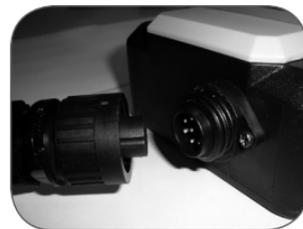
Para encaixe dos cabos das células observe que há uma pequena saliência em um dos lados do conector do módulo WBECK, ela deve ser encaixada no ponto cavado no conector ligado à barra. Depois de encaixado, rosqueie o conector do cabo no sentido horário até que fique bem preso ao indicador. (veja figura 2.)
