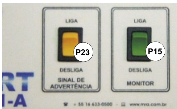
FIGURA 3.9 - FOTO PARCIAL DO PAINEL DO ALERT MOSTRANDO AS CHAVES COLORIDAS TIPO TECLA LIGA/DESLIGA:
