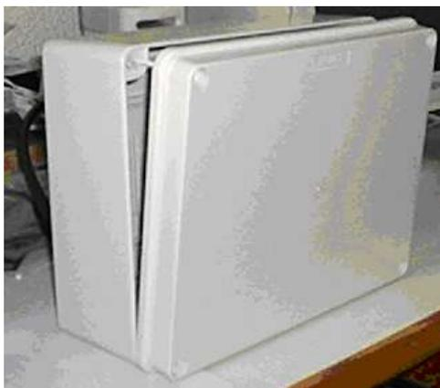
**Figura 2: Caixa hermética para proteção do roteador**
