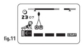
O Compex<sup>®</sup> emite um aviso sonoro e apresenta alternadamente o símbolo de um par de eletrodos e o de uma seta a apontar para o canal em que existe um problema. Acima, o aparelho detectou um defeito no canal 1.
