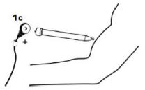
1c Conectar a conexão positiva (vermelha) na extremidade mais larga do lápis do ponto motor. A outra conexão (preta) deve ser ligada ao eletrodo negativo, posicionado de acordo com o desenho, para estimulação do músculo.
