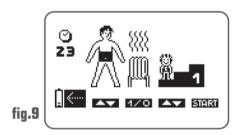
Se a pequena pilha tiver apenas duas marcas, o nível de carga das baterias está a ficar fraco. Termine a sessão e recarreque o aparelho.
