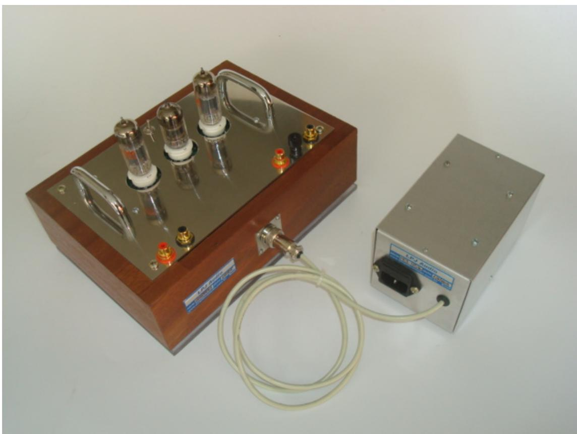
Note que a fonte de alimentação possui um conector com porta-fusível (e em alguns modelos, também a chave liga-desliga) no padrão IEC (USA) onde é possível ligar o cabo de força que vai à tomada de AC (110Vac ou 220Vac conforme solicitado).
