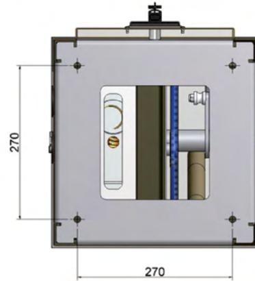
Posicione o equipamento no local desejado para a instalação, retire a porta do mesmo e faça as marcações para a fixação.
