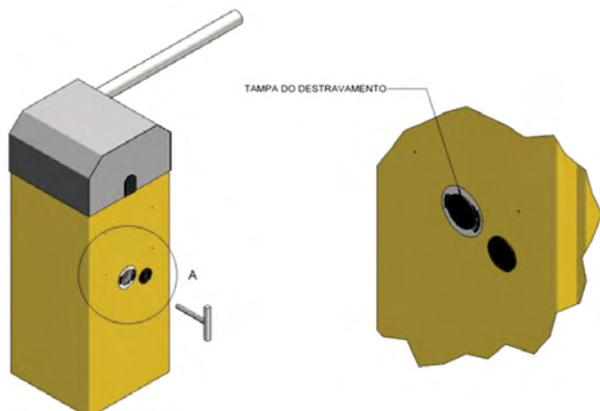
Introduza a chave do destravamento, no parafuso do motor e gire-o no sentido horário. O equipamento esta pronto para ser utilizado manualmente.
