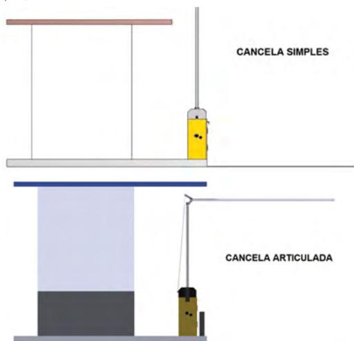
Para determinar o local de instalação deve-se observar a altura da laje. Em caso de local aberto utiliza-se o equipamento simples e em caso de local com laje ou telhado equipamento articulado.
