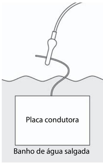
Figura 20 Ligação da placa condutora
