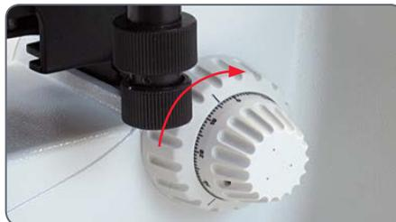
2. Mova o suporte do condensador para a posição mais baixa ao usando botão de foco do condensador à esquerda da instalação da mesa.
