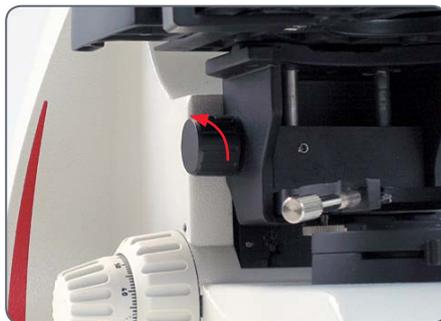
6. Aperte os dois parafusos usando a ferramenta inclusa no pacote entregue (ou, para uma estativa Koehler, aperte os dois parafusos-borboleta) de modo que a lente superior do condensador esteja centrada sob a objetiva na posição funcional e o condensador do subestágio esteja, assim, grosseiramente centrado.
