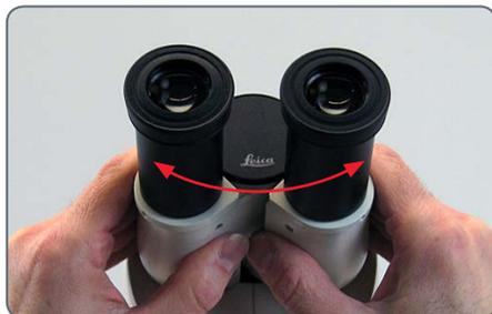
**i** Os canhões de visualização mantêm um comprimento constante do tubo para todos os ajustes interpupilares. Isto significa que uma mudança na distância interpupilar não afeta a distância parfocal, a ampliação ou as calibrações que dependem da ampliação.
