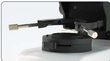
*A instalação do condensador de subestágio é aberta*
