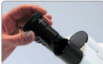
2. Prenda as oculares nos canhões ao apertar os parafusos prateados na base dos canhões usando uma chave de fenda Philips padrão (não inclusa no pacote entregue).
