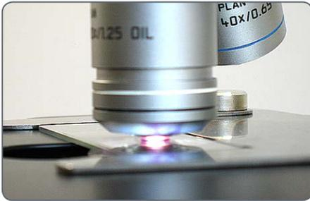
6. Segure o anel recartilhado sobre a objetiva e balance a objetiva para frente e para trás para eliminar bolhas de ar. Então, leve a objetiva a óleo para a posição final, de modo que a gota de óleo esteja entre a lente da frente da objetiva e a lâmina de amostra.
