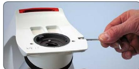
2. Coloque o encaixe tipo cauda de andorinha no tripé e aperte o parafuso cuidadosamente (sem usar força excessiva). Isto posiciona com precisão o canhão de visualização no eixo óptico do microscópio, independente da rotação selecionada.
