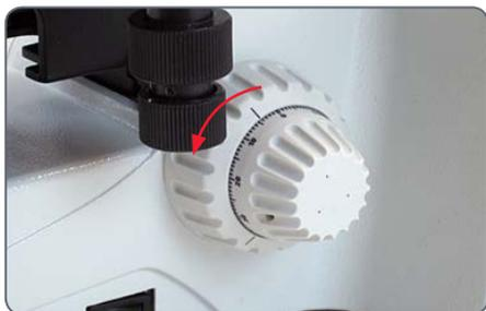
2. Mova a lâmina de amostra para baixo até a menor posição usando o botão de ajuste aproximado.
