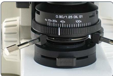
5. Mova o condensador para a posição mais alta usando o botão de foco do condensador à esquerda da instalação da mesa.
