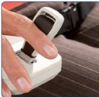
Fig. 2.2 Joystick de Comando (pressão constante)
