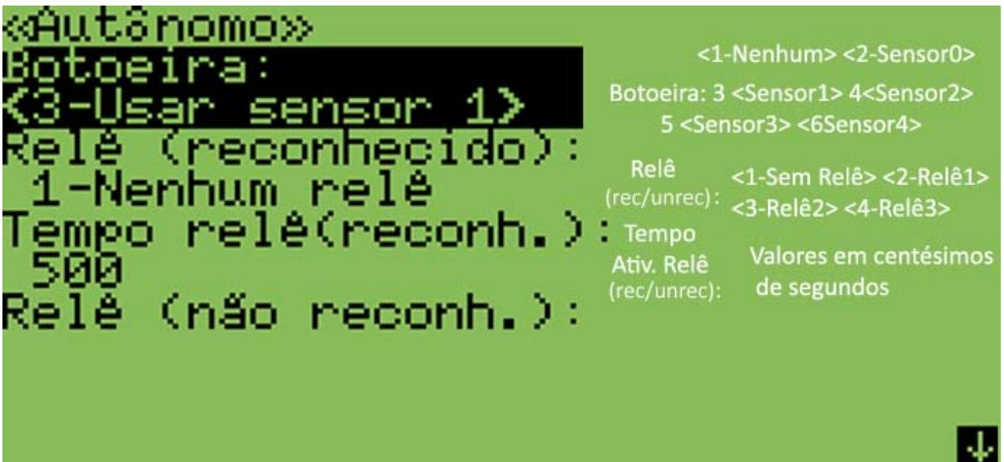
Fig. 46 - Opções do modo “On-line c/srv.”
