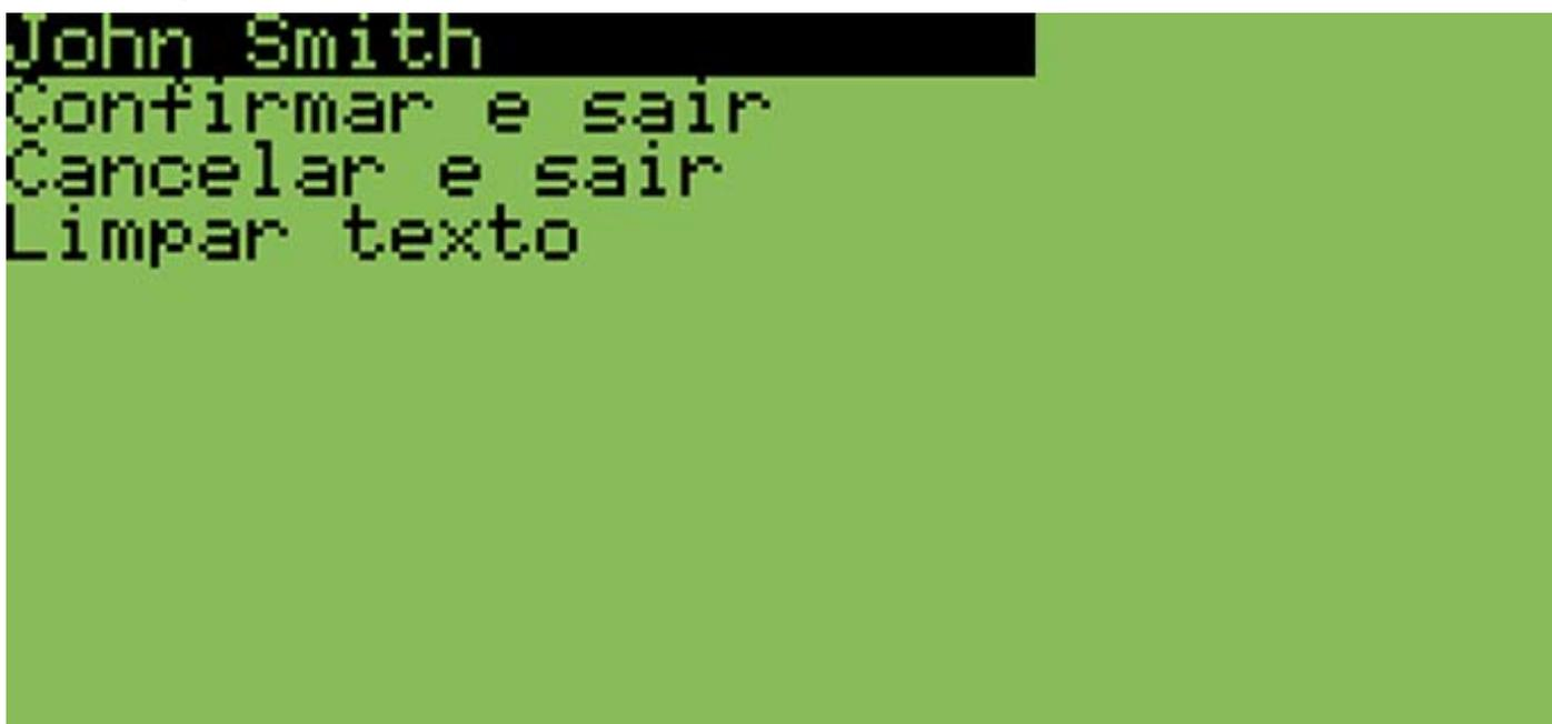
Fig. 30 - Tela de confirmação. Use as teclas de cursor para selecionar uma opção. Pressione [ # ] para confirmar.
