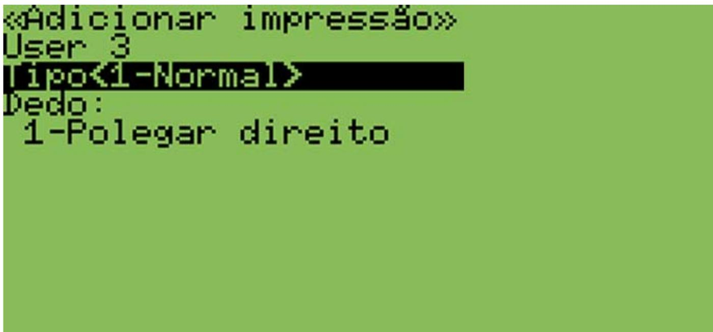
Fig. 23 - Iniciando o procedimento de captura da impressão digital no GAM 110.
