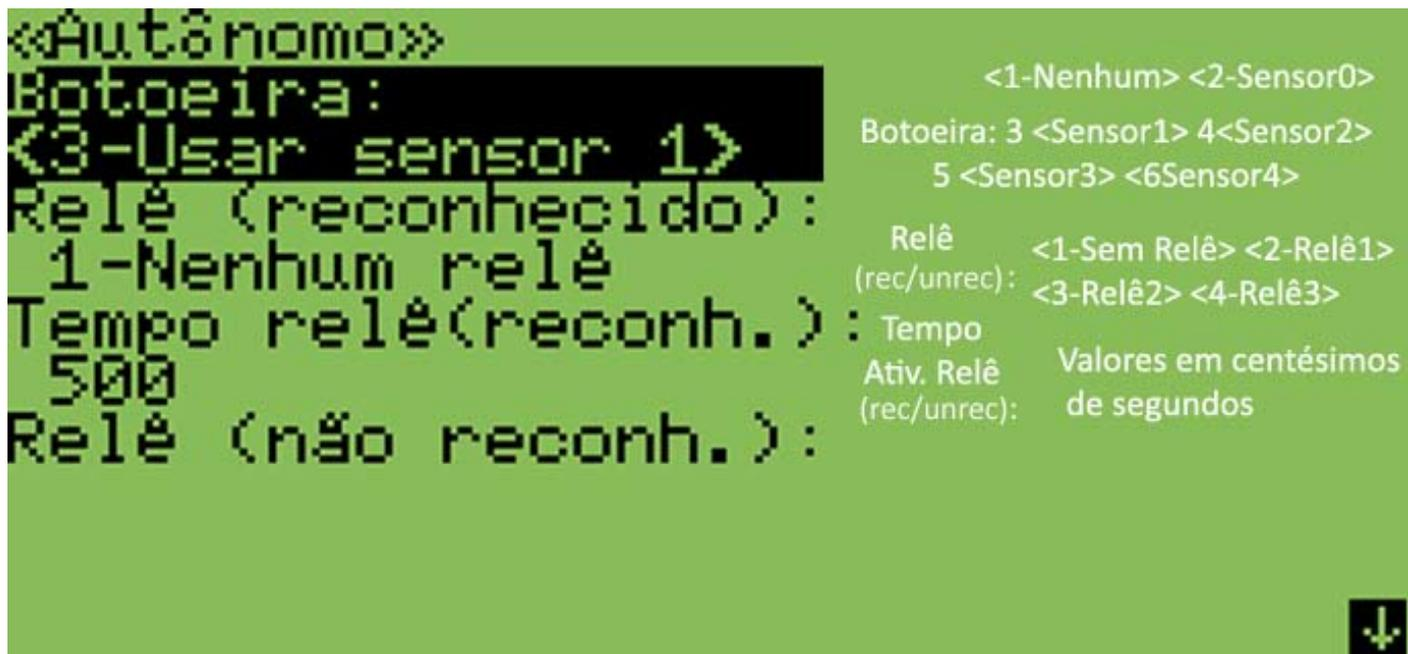
Fig. 45 - As opções do modo “Autônomo”; (Standalone).
