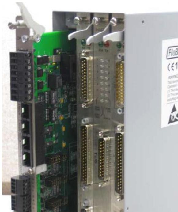
Figura 2-10. Módulo Pronto para Remoção ou Inserção
