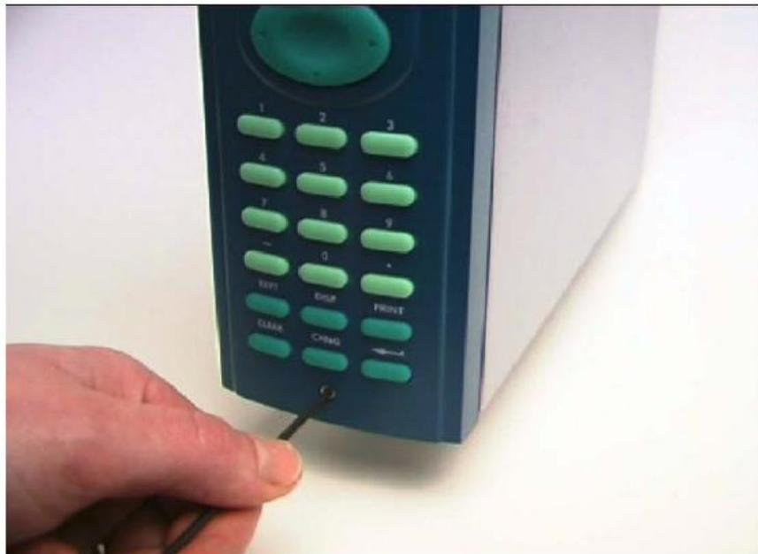
*Figura 2-2. Remoção do Painel Frontal*
